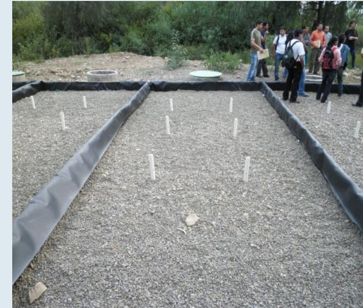
Mô hình thử nghiệm tại Trường Đại học San Simon - Cochabamba - xử lý nước thải từ Khoa Nông nghiệp
